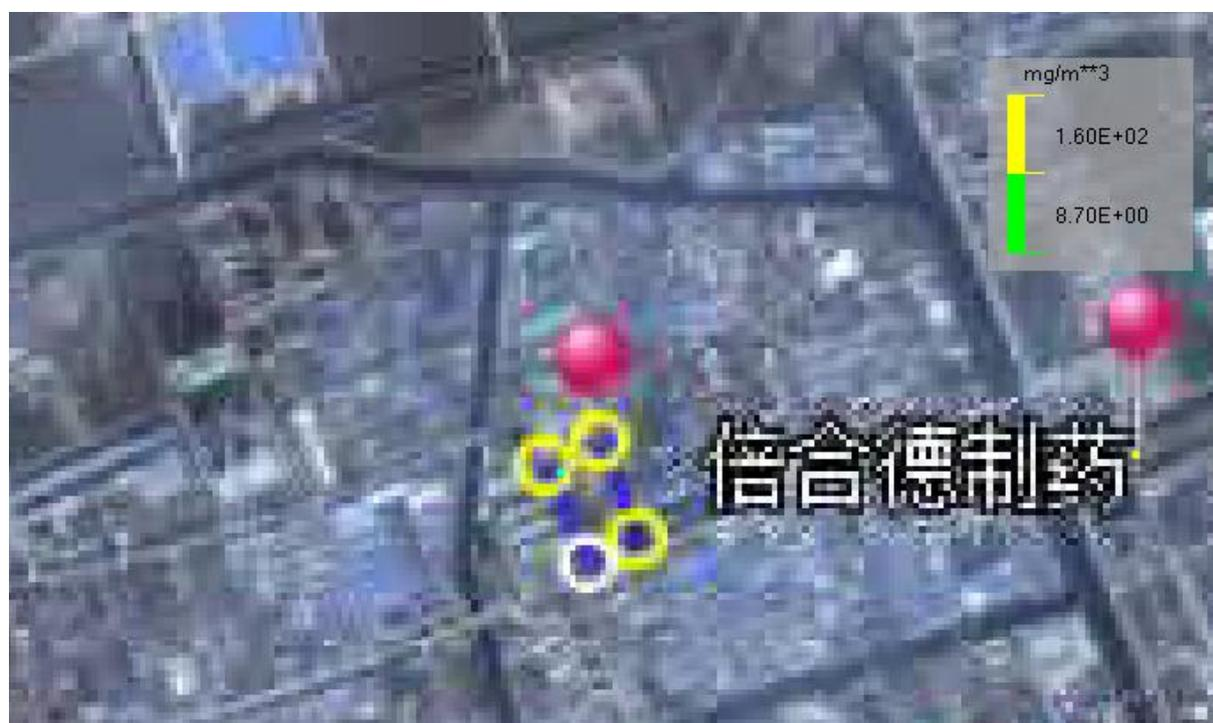
图 6.10.5-1 最常见气象条件下储罐泄漏硫酸排放预测结果
