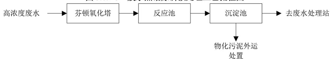
图 3.6.1-4 废水芬顿氧化预处理工艺流程图
